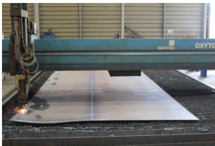
Figura 18 - Fotografias corte das chapas pelo processo Oxicorte (Grupo A)
