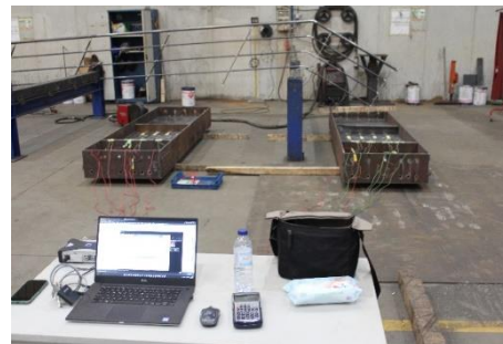
Figura 38 - Disposição dos termopares na alma do perfil para monitorização das temperaturas durante a execução da soldadura
