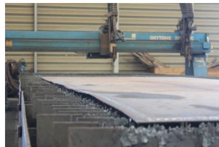
Figura 18 - Fotografias corte das chapas pelo processo Oxicorte (Grupo A)
