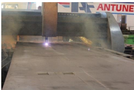
Figura 19 - Fotografias corte das chapas pelo processo Plasma (Grupo B)
