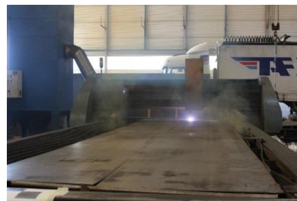
Figura 19 - Fotografias corte das chapas pelo processo Plasma (Grupo B)
