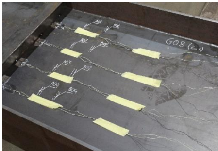
Figura 38 - Disposição dos termopares na alma do perfil para monitorização das temperaturas durante a execução da soldadura
